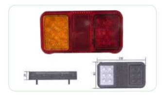
art. 04.1041.000 art. 04.1042.000 Fanale posteriore trattore LED 12/24V, IP66, 3 funzioni: posizione, indicatore di direzione, stop, catarifrangente, con cavo mm250. Misure mm150x80x25
