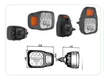
art. 03.357.000 art. 03.358.000 art. 03.359.000 Gruppo faro a LED 12/24V mm218x146x113 con supporto orizzontale (posteriore), luci abbagliante, anabbagliante, posizione, direzione combinata anteriore e posteriore, con connettore DT DEUTSCH a6 poli, IP67/69K, E20
