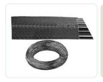
Guaina tessile di protezione ad alta tenuta alle sollecitazioni meccaniche e la compatibilità con oli e prodotti organici, buona tenuta all'abrasione secondo ISO6945, temperature -40°C / +100°C, adatta a proteggere tubi oliodinamici e cavi elettrici (confezioni da 100mt)
