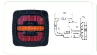
art. 04.1022.000 art. 04.1023.000 Fanali posteriori a LED 12/24V uscita cavo mm1000, IP68, misura mm101x101x35, interasse viti mm45 M5
