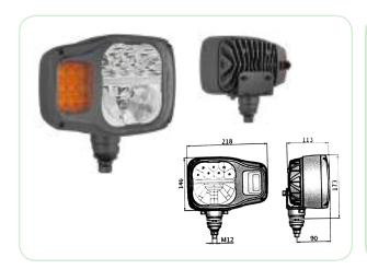
art. 03.355.000 art. 03.356.000 Gruppo faro a LED 12/24V mm218x146x113 con supporto verticale, luci abbagliante, anabbagliante, posizione, direzione combinata anteriore e posteriore, con connettore DT DEUTSCH 6 poli, IP64/69K, E20
