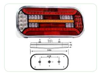
art. 04.1009.000 art. 04.1010.000 Fanale posteriore motrice a LED 12/24V a 6 funzioni: stop, posizione, indicatore di direzione, retro nebbia, retro marcia, catarifrangente. Misure mm.302x134xH51 interasse viti M8x152 cavo mm500
