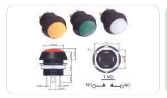
art. 12.595.000 art. 12.596.000 art. 12.597.000 Mini pulsanti instabili illuminati con LED 12V, Ø12, IP67, -40 +85°C, n.4 terminali 2,8x0,5, 28VDC – 5A
